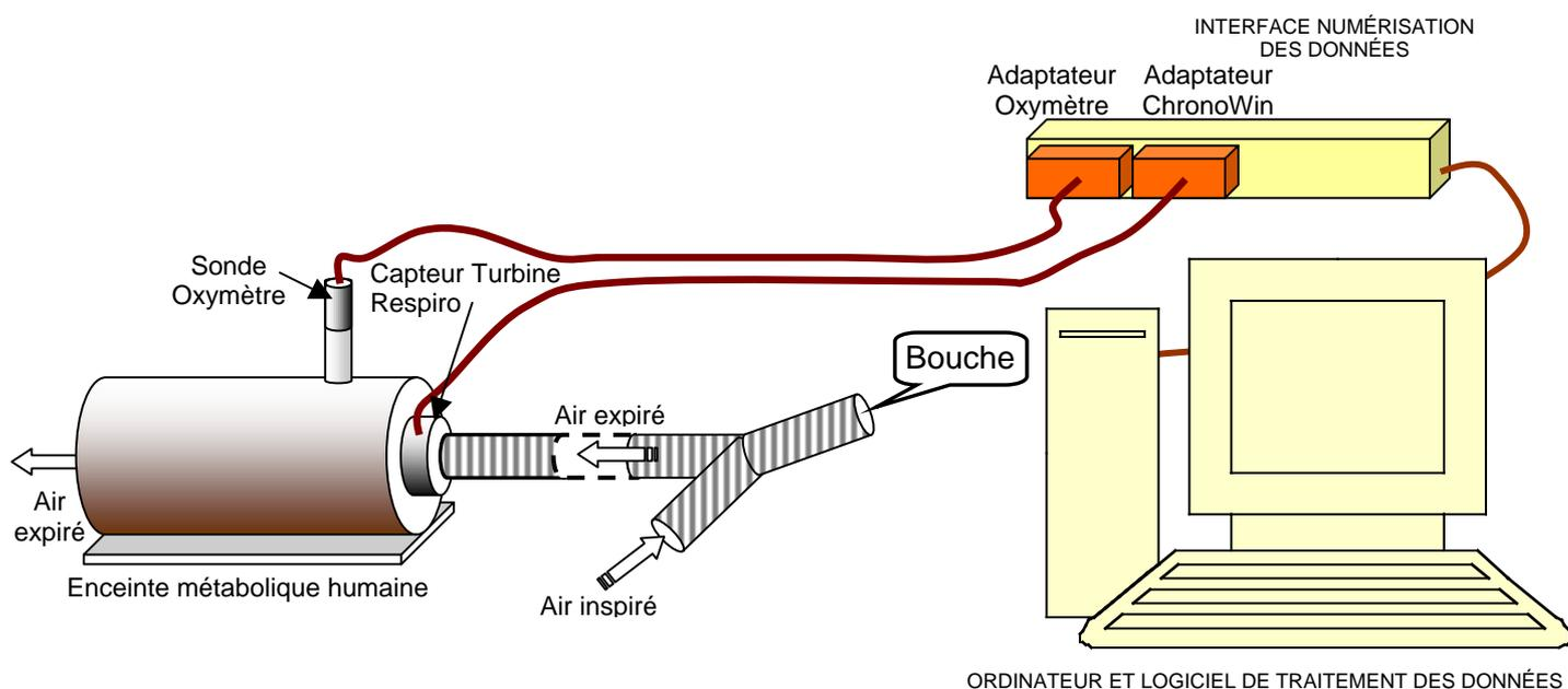
La sonde à dioxygène mesure la teneur en dioxygène de l'air expiré.
