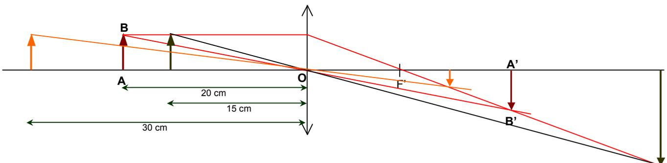
Plus l'objet est proche, plus la distance  $OA'$  est grande. Pour obtenir une image nette lorsque l'objet se rapproche de la lentille, on doit augmenter la distance lentille - écran.
