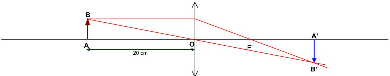
Les opticiens caractérisent une lentille par sa vergence :  $C(\text{en dioptrie}) = \frac{1}{f'(\text{en mètre})}$ .
